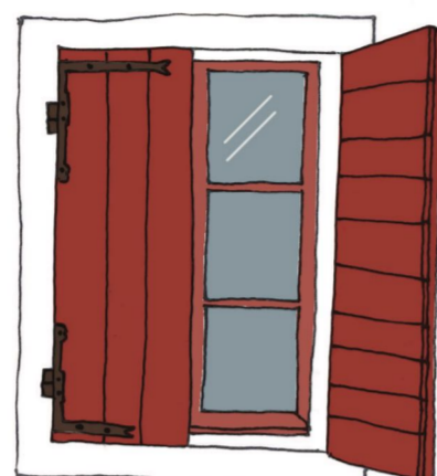
Volets à lames croisées appelés aussi à lames contrariées.
